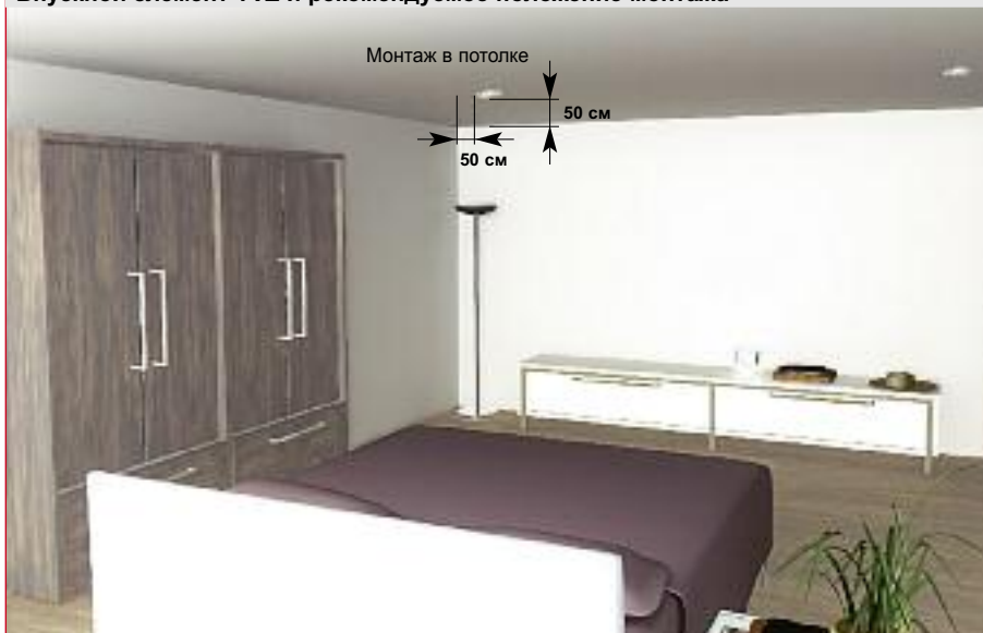
Впускной элемент TVZ и рекомендуемое положение монтажа
