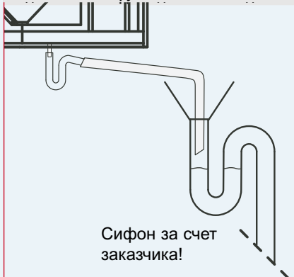
Подключение патрубка для слива конденсата
