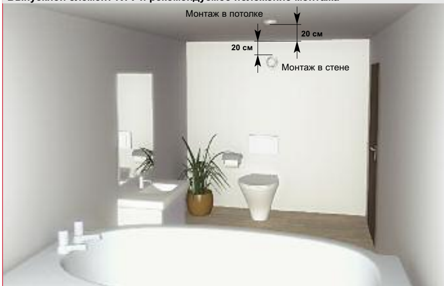
Выпускной элемент KTV и рекомендуемое положение монтажа
