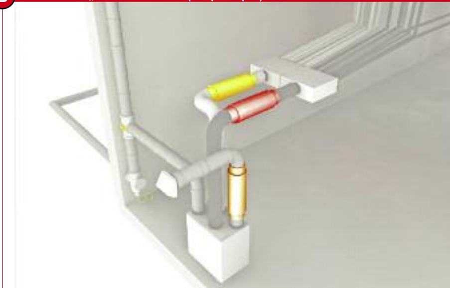
Шумоглушитель на приточном и вытяжном воздуховоде SDE с IsoPipe®
