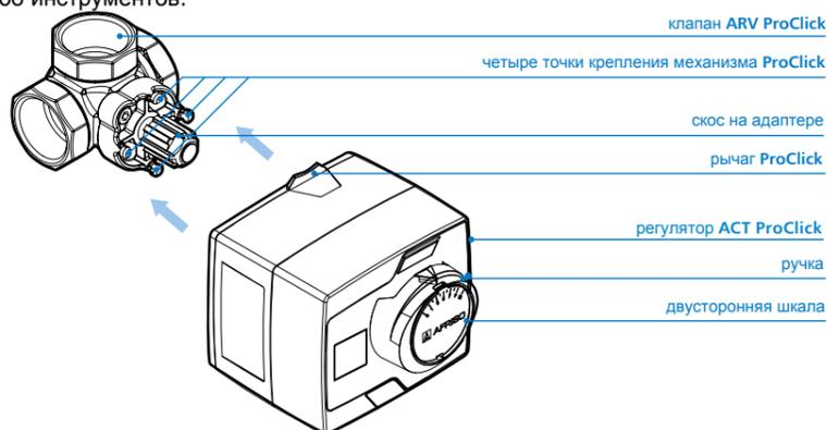
Рис. 7. Установка контроллера постоянной температуры ACT ProClick.
