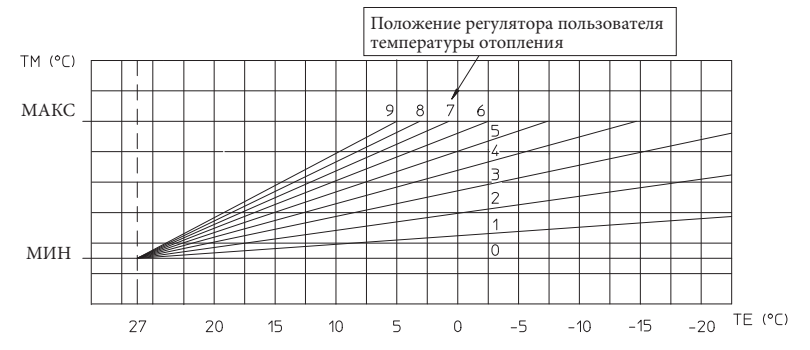
УЛИЧНЫЙ ДАТЧИК Считывает температуру подачи в зависимости от уличной температуры и от настроек пользователя температуры отопления.
