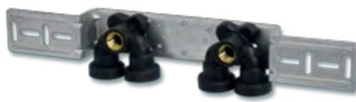
Держатель Roth Typ I/SE (100/153) и настенные U-образные водопроводные розетки Roth из латуни с двойным подключением с гильзами из нержавеющей стали и защитным комплектом для предотвращения передачи шума
