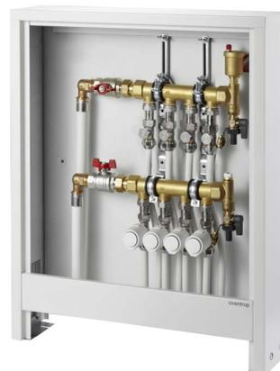
Гребенка сборная из отдельных элементов: концевой элемент, проходной элемент (от 2 до 4 отводов), воздухопускная пробка, шаровый кран, термостатический вентиль „AZ“, вентиль на обратную подводку „Combi 2“, автоматический воздухоотводчик.
