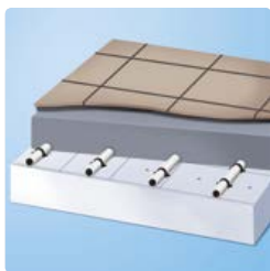
Система креплений степлером Uponor Tacker
