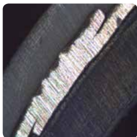
Шов алюминия, сваренного внахлест
