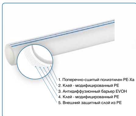
Структура трубы Uponor Comfort Pipe PLUS
