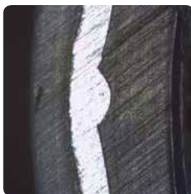
Шов алюминия, сваренного встык
